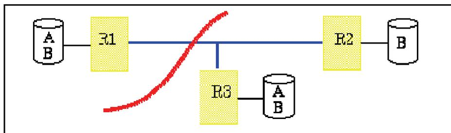
Für die gezeigte Datenverteilung seien für Objekt A die Stimmenverteilung  $\langle 2, -, 1 \rangle$  mit den Quoren  $r=2$ ,  $w=2$  und für Objekt B die Stimmenverteilung  $\langle 1, 3, 1 \rangle$  sowie  $r=2$ ,  $w=4$  gegeben. Aufgrund eines Fehlers im Netzwerk sei ferner die gezeigte Partitionierung des Systems in zwei Teile eingetreten (Partition P1 bestehend aus R1, Partition P2 mit R2 und R3). In welchen Partitionen können die folgenden drei
