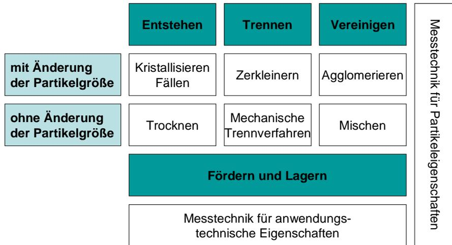
Abbildung 3.10.: Ordnungsschema der Feststoffprozesse
