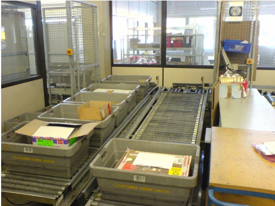
Abbildung 3.1 Klärungsband (NiO) bei Lufthansa Technik Hamburg (eigenes Foto)
