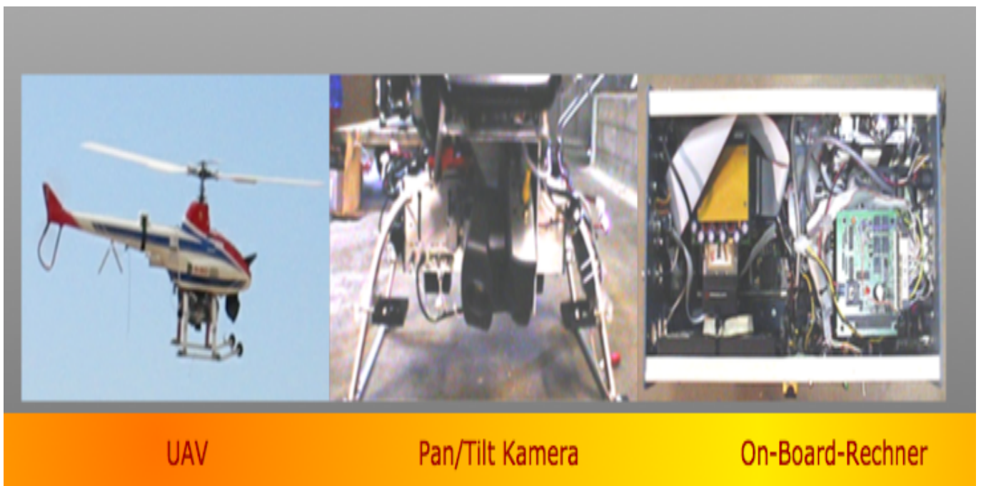
Bild 2.7: UAV mit eingebauter Kamera und eingebautem Rechner
